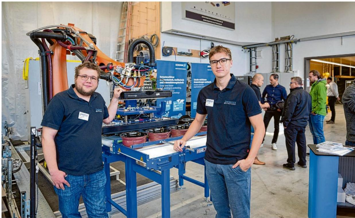
Magnus Berroth (links) und Nico Baier erklären, wie der Kuka-Titan-Roboter WMF-Töpfe depaletteert und einer Schleifmaschine zuführt, die ihren Rand schleift. Danach werden die Töpfe wieder vollautomatisch durch den Roboter palettiert. *Foto: Andreas Scholz*
